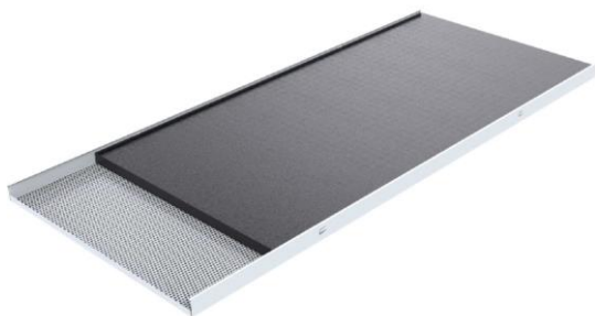
Rockwool 30 mm bagged film PU LR30 PU Alpha w = 0.95
