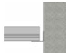
Démontage : Ouverture par poussée verticale du bac.
